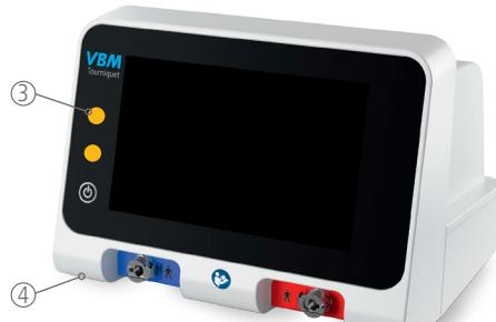
Jednotka potom spustí vizuálny alarm ③ a zvukový alarm ④.
